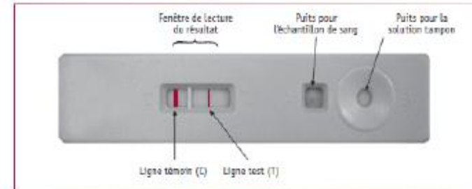
Représentation schématique d'une cassette de TDR
